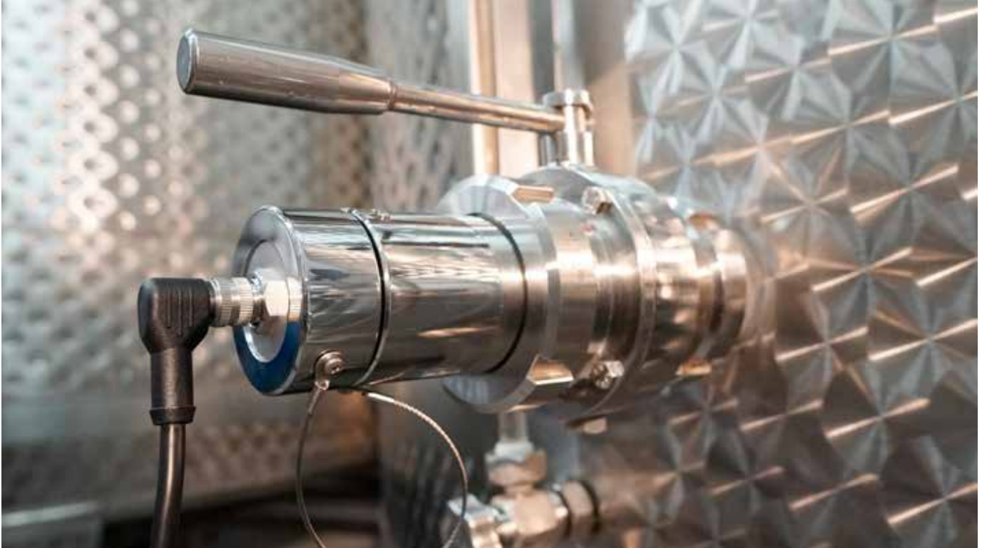
Réfractomètre digital VinPilot® Brix inséré à travers un robinet à tournant sphérique DN 50.
