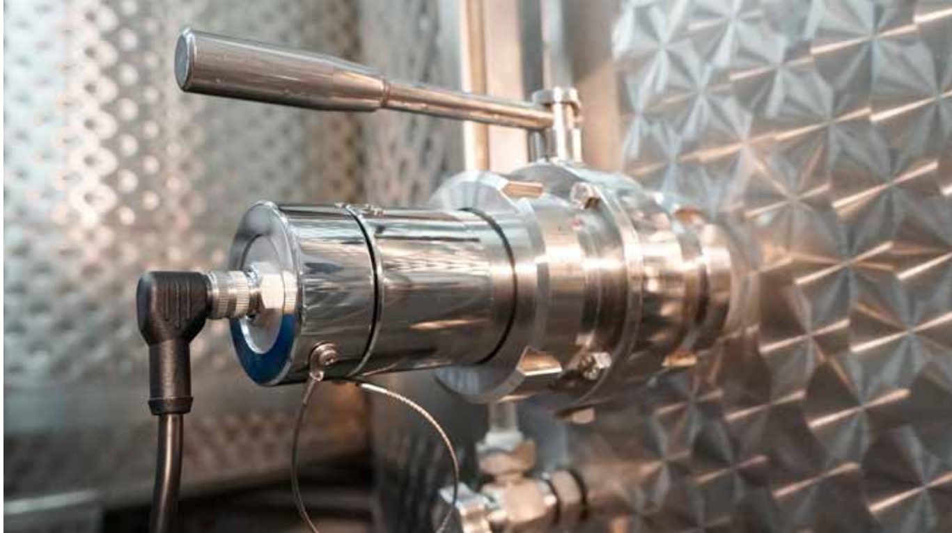
Rifrattometro digitale VinPilot® Brix inserito attraverso una valvola a sfera.
